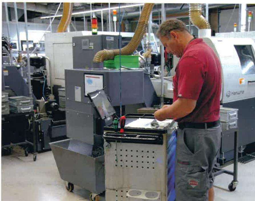
Gabor Grünwald, Betriebsleiter und einer der „Key-User“ der GEWATEC-Software bei Loga Präzisionsteile, bei der Werkstückprüfung am mobilen Messplatz. Im Hintergrund eine Drehmaschine mit dem ProVis-Terminal zur MDE
