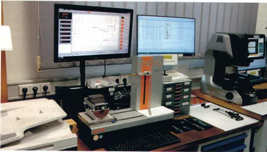
Ein 4-Achs-CNC-Kontur- und Rauheitsmessgerät in der Qualitätssicherung von Loga – rechts der Bildschirm der Messwertaufnahme
